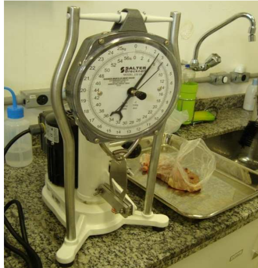
Figura 6. Aparelho Warner-Bratzler – mensuração da força de cisalhamento Fonte: arquivo pessoal Nina Toralles Caniello e Rodrigo Vidal Oliveira
