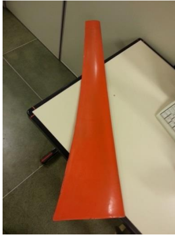
Figura 25 – Pá modelo para a produção do molde fêmea e das pás de fibra de carbono
