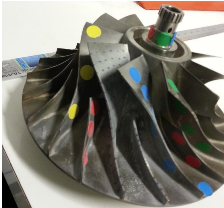
Figura 37 – Rotor preparado para digitalização
