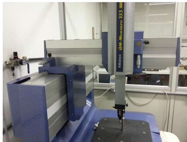
Figura 19 - braço da máquina de medir por coordenadas QM-Measure 353
