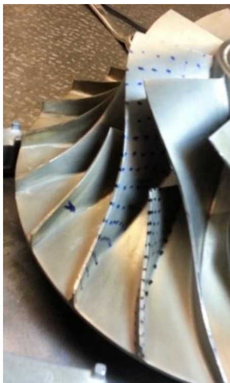
Figura 36 - Malha de pontos desenhada na pá para medição
