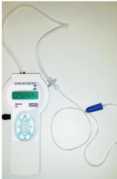
**Figura 2:** probe nasal de silicone conectado ao manovacuômetro digital por um cateter.
