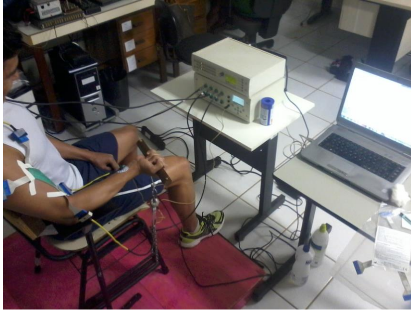
Figura 12. Voluntário posicionado para início do procedimento de aquisição do EMG-S.
