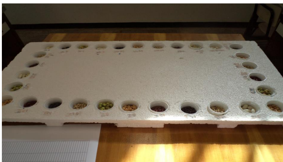
Figura 1. Arena usada nos ensaios de antixenose contendo 30 orifícios destinados a acomodar recipientes de plástico de 50 mL de capacidade com 20 g de grãos dos genótipos sob teste.
